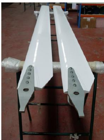
شکل (۳)، چگونگی قرارگیری پره های روتور بر روی زمین
