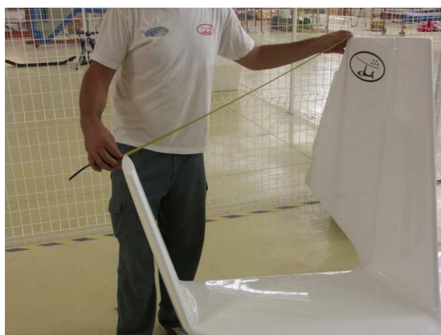
شکل (۲)، شماتیک اندازه گیری فاصله رادر تا بالچه دم.
