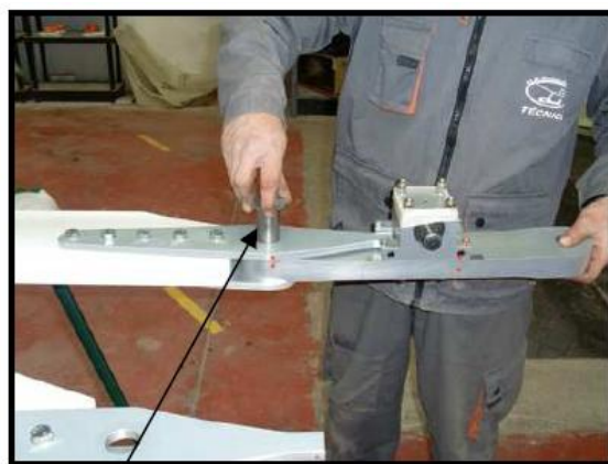
جا زدن پین پیچی
